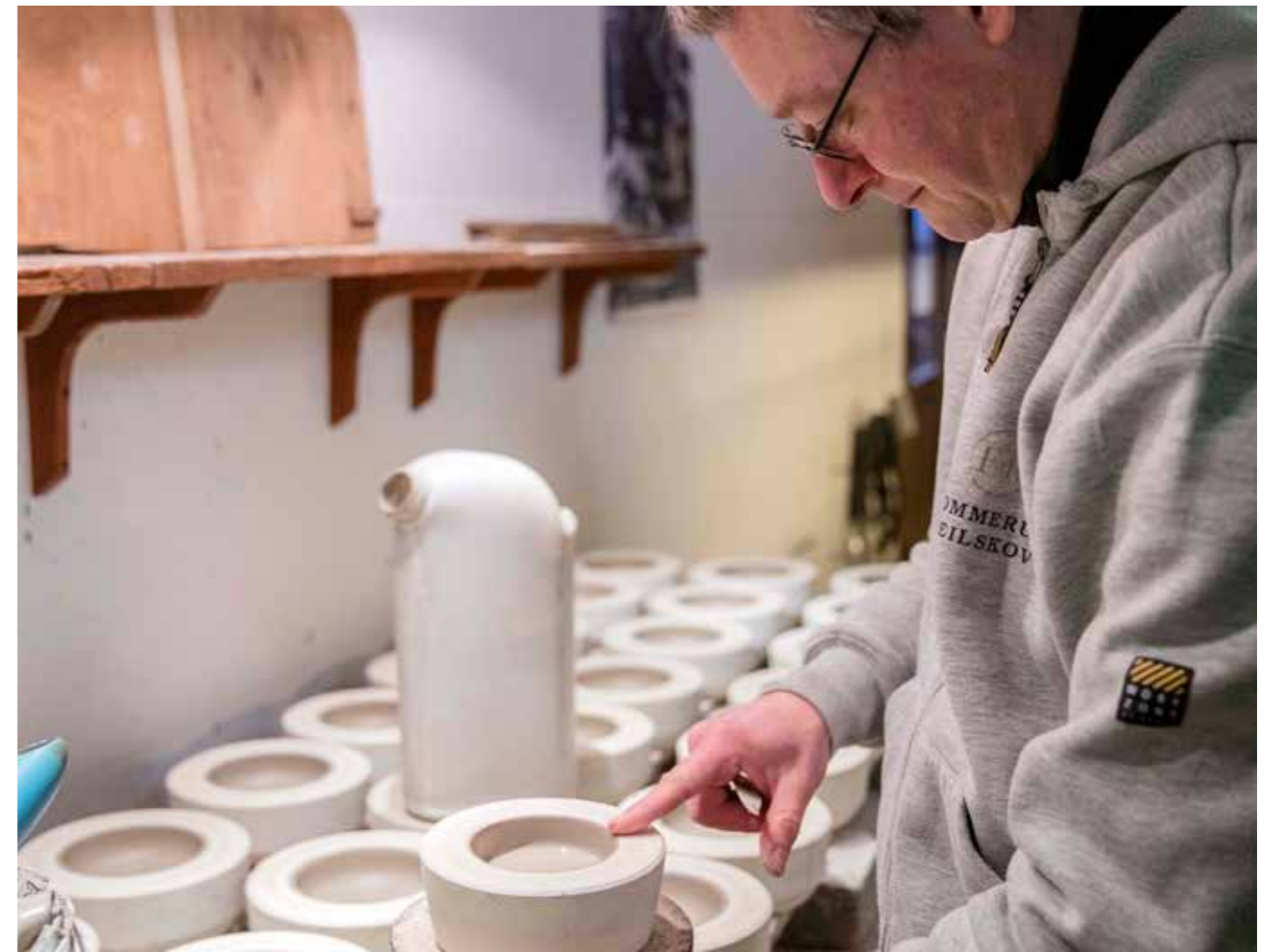
Når urnen kommer ud af støbepap, afgratter Kim Boisen den på en drejebænk, så den får en fin, glat overflade.
